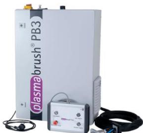
プラズマブラッシュ PB3 Integrationは、生産プラントでの設置用に開発された完全システムです。制御はリモートコントロールまたは上位制御システムとの接続により行います。
