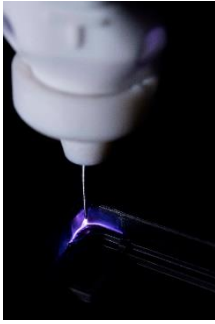
Bild 2: Plasmabehandlung mit dem PiezoBrush PZ3 vor dem Verkleben
