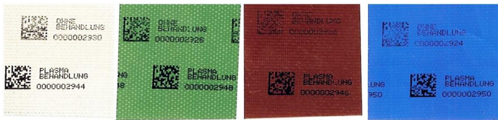
Bild 4: Vergleich Druckbild ohne Plasma-Vorbehandlung (oben) und nach vorheriger Plasmabehandlung (unten)
