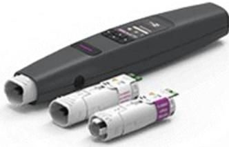
Der PiezoBrush PZ3 ist als kompaktes Plasma-Handgerät für den Einsatz in Laboren, der Vorentwicklung und der Montage von Kleinserien entwickelt worden. Bei einer maximalen Leistungsaufnahme von 18 W wird mithilfe der Piezoelectric Direct Discharge (PDD®) Technologie kaltaktives Plasma mit einer Temperatur von weniger als 50°C erzeugt.
