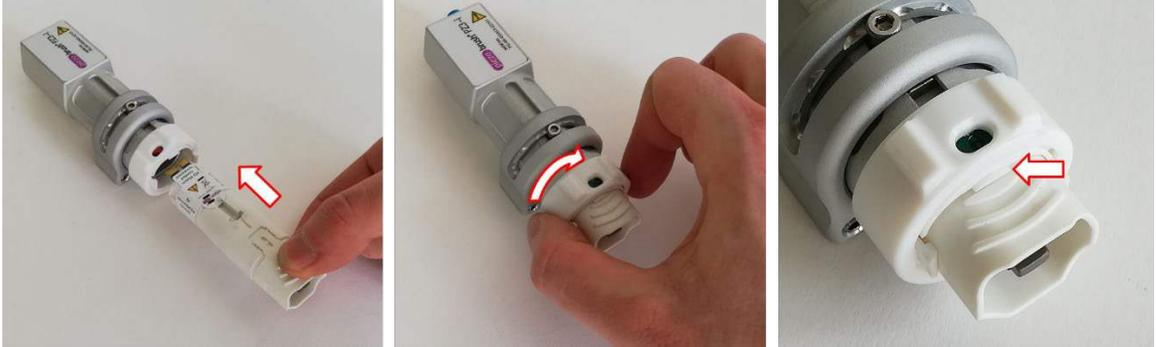
Agarre el soporte del módulo como se muestra en la imagen y colóquelo en la carcasa del excitador deslizándolo sobre los dos pernos de fijación desde la parte delantera y presionándolo a continuación contra la carcasa del excitador hasta el tope.
