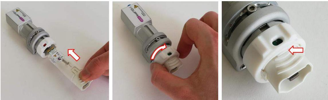
如图所示，抓住模块载体，将其置于驱动器外壳上，从前方推到两个定位销上，然后将其完全压入驱动器外壳。
