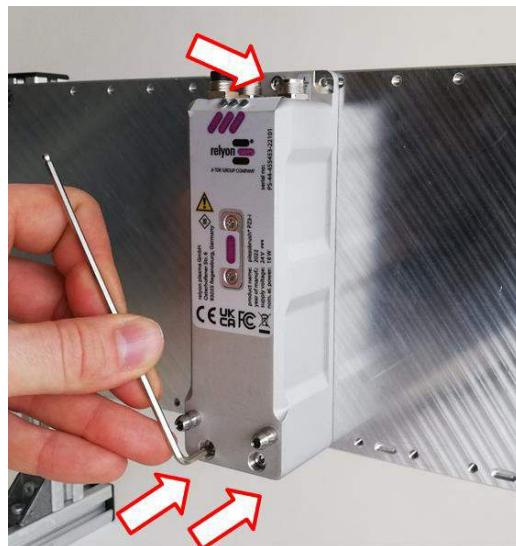
将模块载体上的锁紧环向左转到“打开”位置（红色）。将所需切换模块插入模块载体。为此，如图所示，在不触及压电元件的前提下，从外侧抓住其前部区域。确保贴纸朝上，将切换模块插入模块载体中。确保将切换模块插入如图所示的深度。将模块载体上的锁紧环向右转到“关闭”位置（绿色）。
