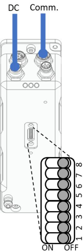
采用数字 I/O 通信的单个设备示意图。在配置端口所需的设置在交付状态下已经设置好了，不需要为这种操作模式进行调整。为清楚起见，在此没有示出可拆卸的模块载体、模块连接电缆和气体管道。
