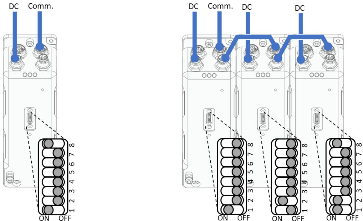
采用 CANopen 通信的单台设备示意图（左）和一排三台采用 CANopen 通信的设备示意图（右），以及每台设备在配置端口上的必要设置。为了清楚起见，在此没有示出可拆卸的模块载体、模块连接电缆和气体管道。
