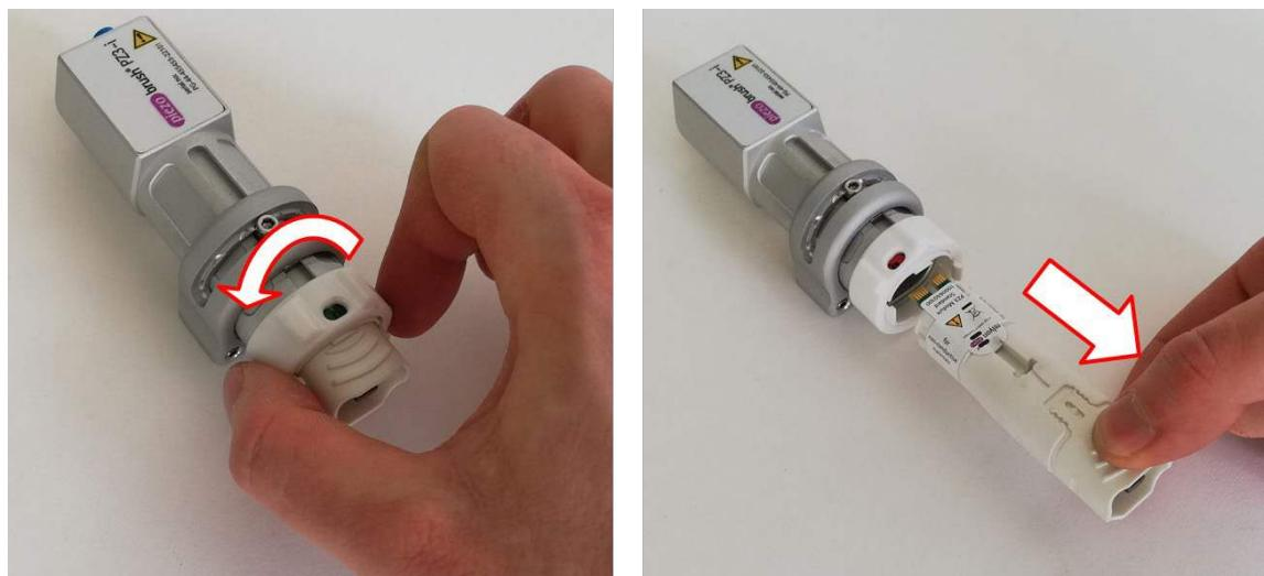
如果由于安装情况，在安装时无法向下取出切换模块，则应在不使用工具的情况下，将模块载体与模块一起取下。为避免损坏模块电缆，我们建议在取下模块载体之前将其拔掉。将模块载体向前抽出驱动单元，然后按上述方法取出切换模块。
