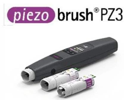
PiezoBrush PZ3 为紧凑型手持式等离子设备，适合实验室、预开发和小批量装配用途。该设备采用压电直接放电（Piezoelectric Direct Discharge, PDD®）技术，最大功耗为 18 W，可产生温度低于 50°C 的冷等离子体。
