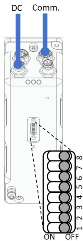
采用数字 I/O 通信的单个设备示意图。在配置端口所需的设置在交付状态下已经设置好了，不需要为这种操作模式进行调整。为清楚起见，在此没有示出可拆卸的模块载体、模块连接电缆和气体管道。
