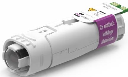
El aparato solo puede producir una activación de superficie si hay un sustrato conductor de electricidad delante del dispositivo dentro del rango de la distancia de trabajo permitida. Esto es aproximadamente de 0.5 a 2.0 mm. Si la distancia es mayor, la generación de plasma puede no ser posible, dependiendo del material y la forma del sustrato.
