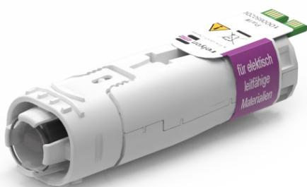
Das Gerät kann nur eine Oberflächenaktivierung erzeugen, wenn vor dem Gerät ein elektrisch leitfähiges Substrat im Bereich des zulässigen Arbeitsabstands ist. Dieser beträgt ca. 0,5 bis 2,0 mm. Bei größerem Abstand kann je nach Material und Form Ihres Substrates unter Umständen keine Plasmaerzeugung stattfinden. Wenn ein zu großer Abstand gewählt wird, stoppt das Gerät nach 5 Sekunden automatisch die Plasmaerzeugung.
