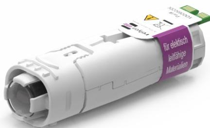
L'appareil peut uniquement générer une activation de surface si un substrat électroconducteur se trouve devant lui à la distance de travail autorisée. Cette distance est d'environ 0,5 à 2,0 mm. Si la distance est supérieure, en fonction du matériau et de la forme de votre substrat, aucune génération de plasma ne peut avoir lieu dans certaines circonstances. Si une distance trop importante est sélectionnée, l'appareil arrête automatiquement la génération de plasma au bout de 5 secondes.
