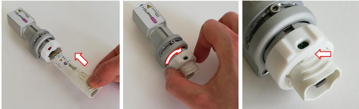
Saisissez le porte-module comme illustré et placez-le sur le boîtier d' entraînement en l'insérant sur les deux goupilles de positionnement puis en l'appuyant contre le boîtier d' entraînement jusqu'en butée.
