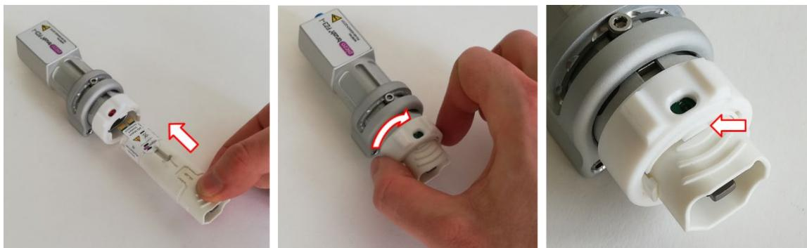
Attendez que le module interchangeable refroidisse avant de le retirer. En fonction du module, l'exploitation peut entraîner un échauffement important.
