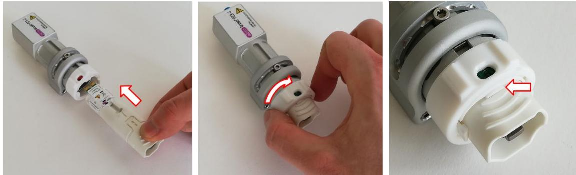
Afferrare il portamodulo come raffigurato e posizionarlo sul corpo driver spingendolo dal lato anteriore sui due perni di alloggiamento e premendolo poi fino all'arresto sul corpo driver.
