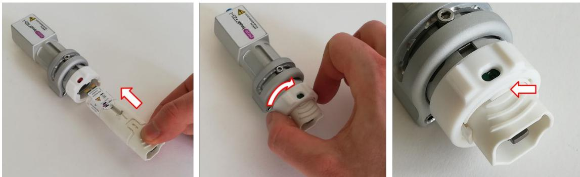
Greifen Sie den Modulträger wie abgebildet und setzen Sie ihn auf das Treibergehäuse auf, indem Sie ihn von vorne auf die beiden Aufnahmestifte schieben und dann bis zum Anschlag an das Treibergehäuse andrücken.
