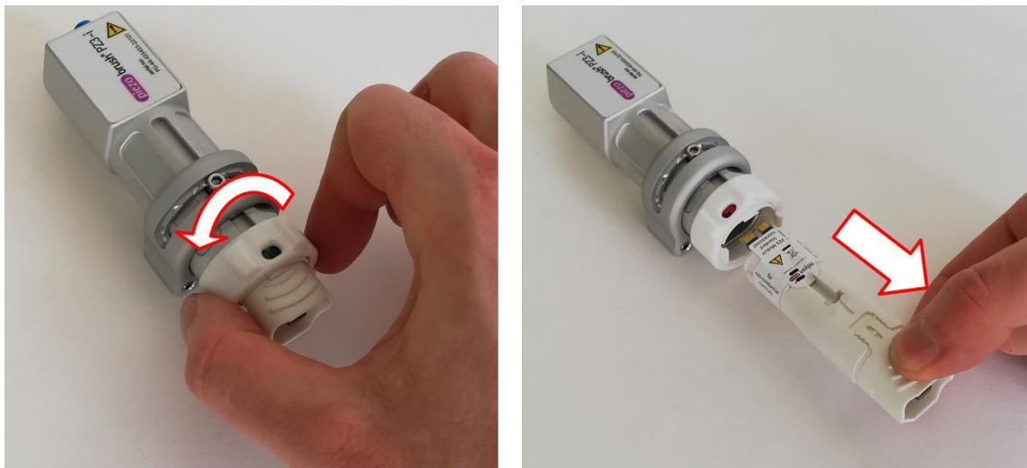
如果由于安装情况，在安装时无法向下取出切换模块，则应在不使用工具的情况下，将模块载体与模块一起取下。为避免损坏模块电缆，我们建议在取下模块载体之前将其拔掉。
