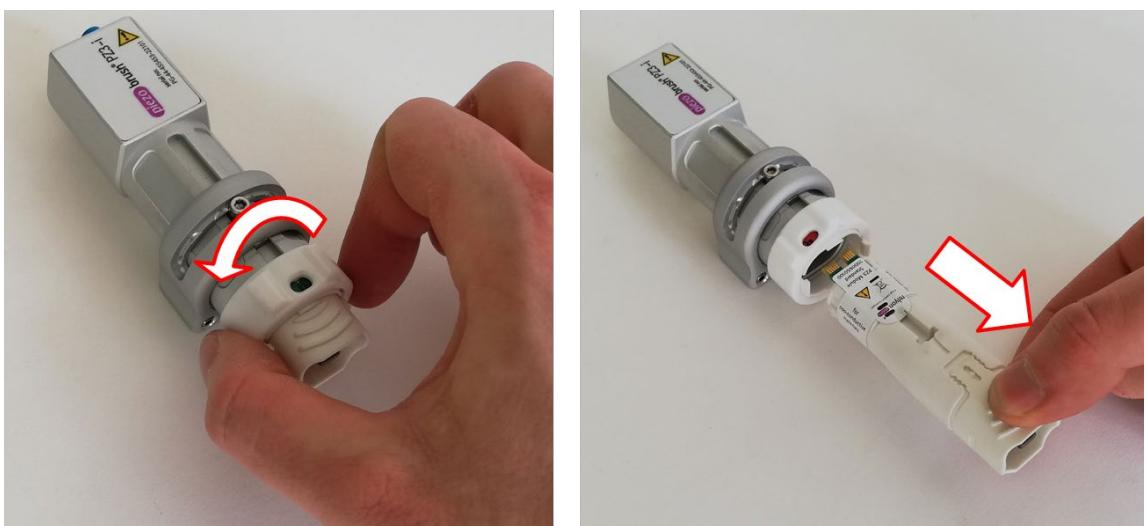
Si la position de montage empêche le retrait par le bas du module interchangeable à l'état monté, le porte-module doit être retiré avec le module sans outil. Pour éviter d'endommager le câble du module, nous conseillons de le débrancher avant de retirer le porte-module.
