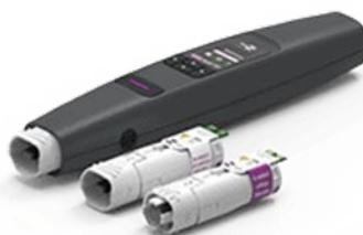
ピエゾブラッシュ PZ3は、ラボや事前開発、小型シリーズの組み立てに使用するコンパクトなハンドヘルドプラズマ装置として開発されました。最大消費電力は18Wで、ピエゾ素子直接放電（「Piezoelectric Direct Discharge」、PDD®）技術により、50°C以下の温度で低温活性プラズマを生成することができます。
