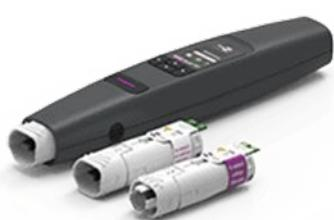
PiezoBrush PZ3 è un dispositivo palmare al plasma compatto sviluppato per l'uso in laboratori, in fase di pre-sviluppo e nel montaggio di piccole serie. Con una potenza assorbita massima di 18 W, con l'ausilio della tecnologia a scarica diretta piezoelettrica (Piezoelectric Direct Discharge, PDD®) genera un plasma freddo-attivo a una temperatura inferiore a 50 °C.
