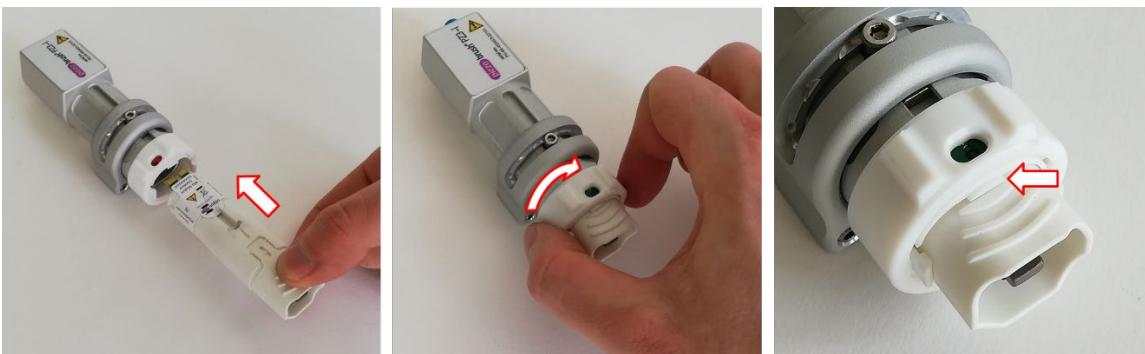
Agarre el soporte del módulo como se muestra en la imagen y colóquelo en la carcasa del excitador deslizándolo sobre los dos pernos de fijación desde la parte delantera y presionándolo a continuación contra la carcasa del excitador hasta el tope.
