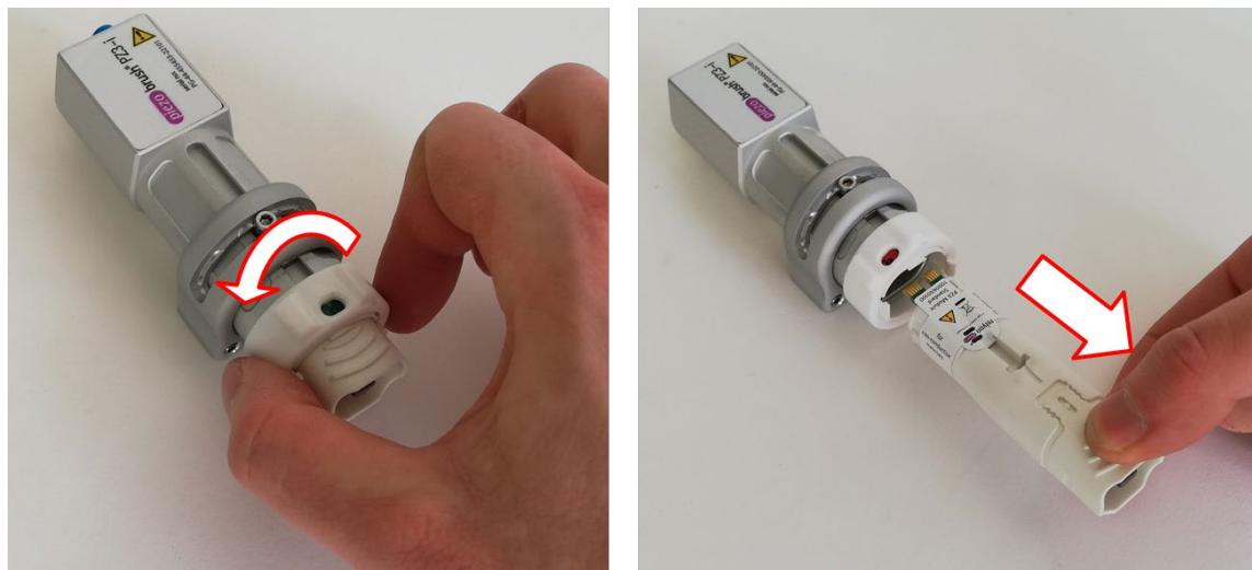
Sollte aufgrund Ihrer Einbausituation das Wechselmodul im montierten Zustand nicht nach unten entnommen werden können, so ist der Modulträger samt Modul ohne Werkzeug abzunehmen. Um eine Beschädigung der Modulleitung zu vermeiden, empfehlen wir, diese vor Abnehmen des Modulträgers abzustecken.
