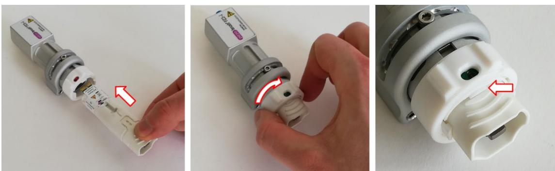
Per rimuovere un modulo intercambiabile, innanzitutto aspettare che si sia raffreddato. A seconda del modulo intercambiabile, il funzionamento può causare un notevole riscaldamento.
