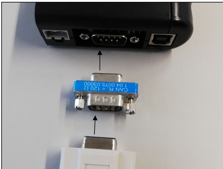
Abbildung 6: Verkabelung an X-gateway
