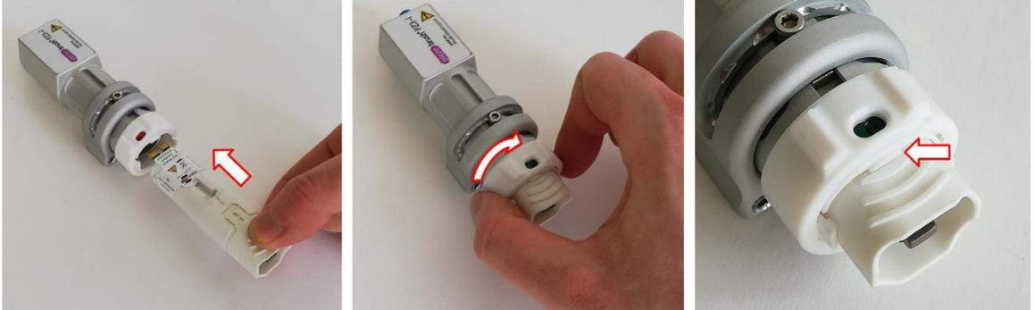
モジュールキャリアを図のように持ち、前から両方の位置決めピン上にスライドさせ、最終位置までドライバー筐体に押し付けるようにしてモジュールキャリアをドライバー筐体に設置します。
