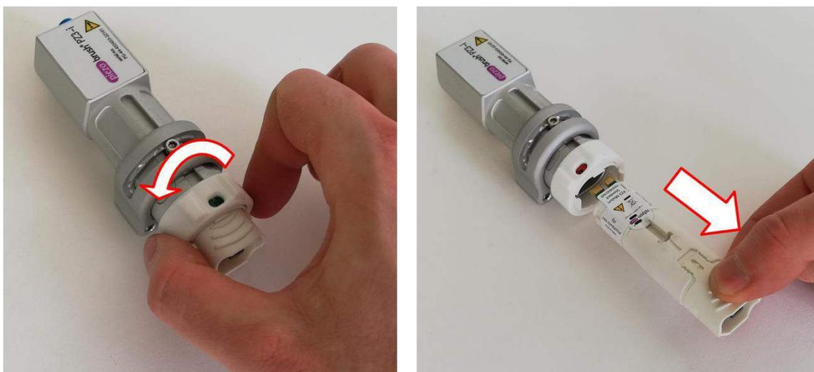
お客様側の設置状況により、その組み立て状態では交換モジュールを下方に取り外せない場合は、モジュールごとモジュールキャリアを工具なしで取り外す必要があります。モジュールケーブルの損傷を避けるため、モジュールキャリアを取り外す前に、モジュールケーブルのプラグを抜くことをお勧めします。
