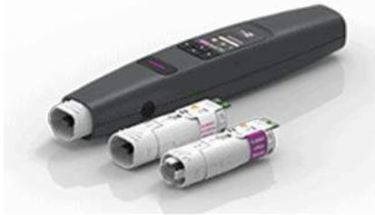
ピエゾブラッシュ® PZ3は、ラボや事前開発、小型シリーズの組み立てに使用するコンパクトなハンドヘルドプラズマ装置として開発されました。最大消費電力は18Wで、ピエゾ素子直接放電（「Piezoelectric Direct Discharge」、PDD®）技術により、50°C以下の温度で低温活性プラズマを生成することができます。
