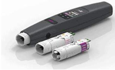
El piezobrush® PZ3 está diseñado como equipo de plasma manual compacto para el uso en laboratorios, predesarrollo y montaje de pequeñas series. Con un consumo de potencia máximo de 18 W, se genera un plasma activo en frío a una temperatura inferior a 50 °C con ayuda de la tecnología Piezoelectric Direct Discharge (PDD®).
