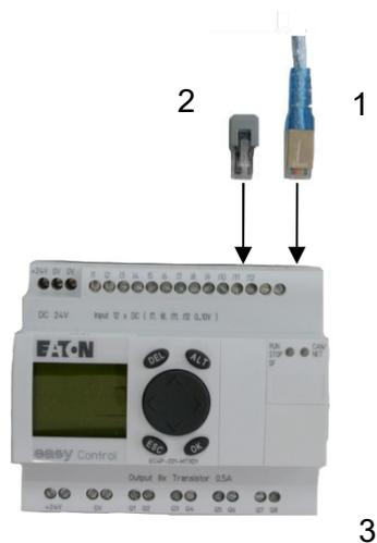
4. Conecte la línea CAN (#4) con el cable adaptador CAN (#1).
