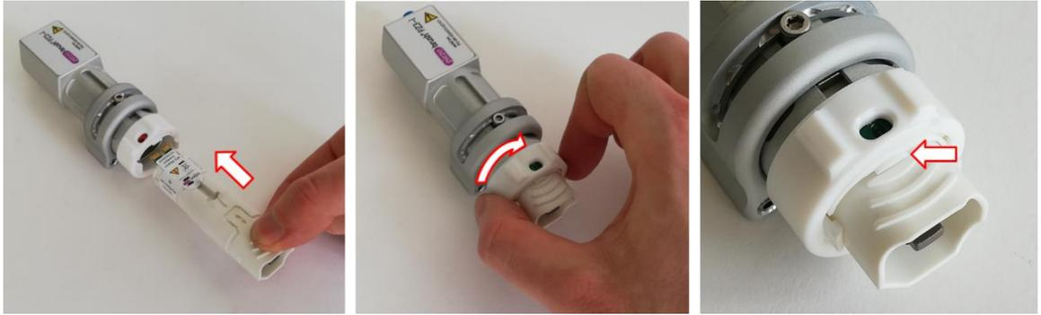
Um ein Wechselmodul zu entnehmen, warten Sie zunächst, bis dieses abgekühlt ist. Je nach Wechselmodul kann der Betrieb zu einer deutlichen Erwärmung führen.
