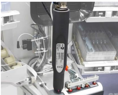
Image 3: Utilisation du modèle prédécesseur piezobrush® PZ2-i pour le collage de polypropylène (PP). Source : IKA®-Werke GmbH & Co. KG
