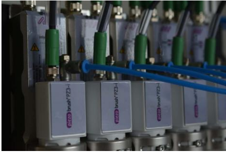
Image 2: Juxtaposition de plusieurs appareils individuels piezobrush® PZ3-i pour des largeurs de traitement plus grandes.
