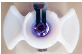
Bild 4: Plasmaentladung eines Dentalimplantates im implaPrep Konzept
