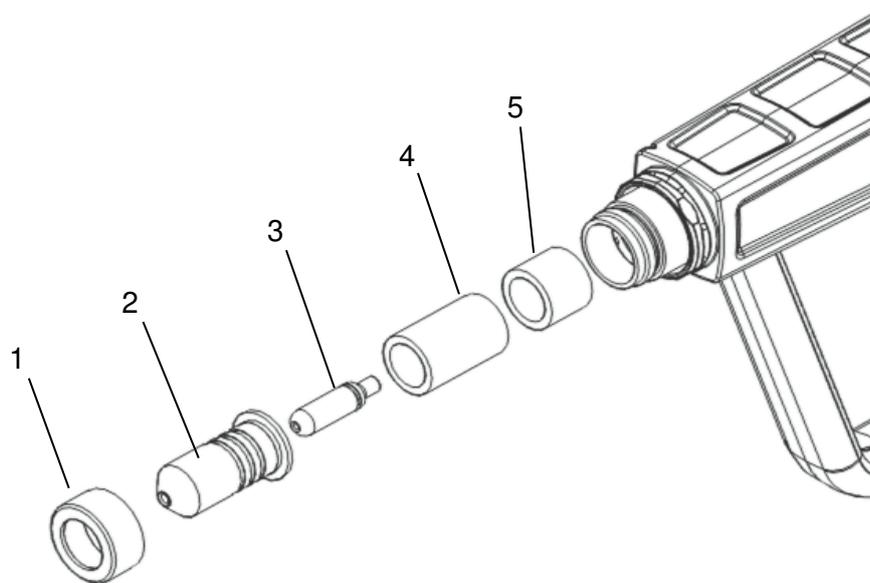
Para cambiar la boquilla y el electrodo realice los siguientes pasos:
