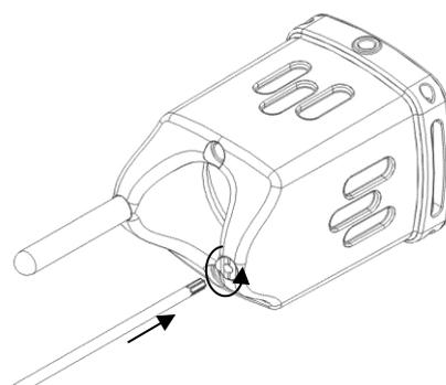
Los soportes pueden desatornillarse o atornillarse manualmente.
