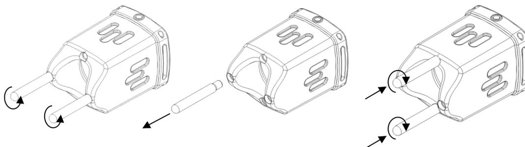
Los dos soportes del distanciador pueden atornillarse desenroscándolos en dos posiciones situadas más abajo. De este modo, se ajusta una distancia de trabajo más corta y se genera así un tratamiento de plasma más intenso con la misma duración de tratamiento. Cuidado: En este caso, la entrada de temperatura en el sustrato también es más elevada.
