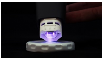
Bild 4: Plasmaentladung an der Spitze des piezobrush® PZ3 mit dem Modul Nearfield
