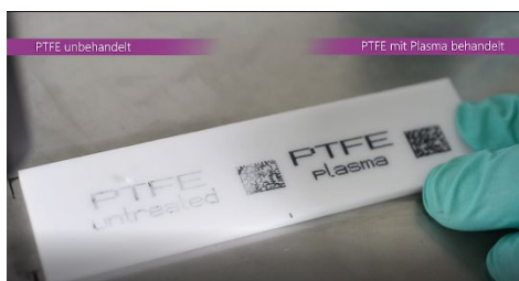
Bild 2: Haftungsprobe von Inkjetdruck auf unbehandeltem und plasmabehandeltem PTFE
