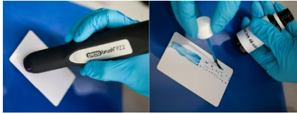
Bild 2: Überprüfung der Oberflächenenergie mit Hilfe von Testtinten vor und nach der Plasmabehandlung
