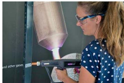
Der Lichtbogen des Plasmabrush PB3 Systems kann auf leitfähige, geerdete Substrate übertragen werden. Dadurch können Lack- und Oxidschichten aufgebrochen werden. In diesem Beispiel kann mit dem Hochleistungshandgerät Plasmatool ein Stahlträger punktuell von Acryllack befreit werden, um etwa Instandhaltungsmaßnahmen durchzuführen.
