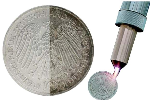
Durch die Verwendung von Formiergas 95/5 als Plasmagas können mit dem Plasmabrush System effektiv Oxide auf Metalloberflächen entfernt (reduziert) werden. Die Umstellung von Druckluft- auf
