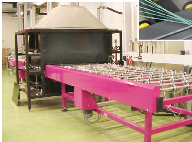
Auch großformatige Glasscheiben können im Pyrosil-Verfahren behandelt werden.
