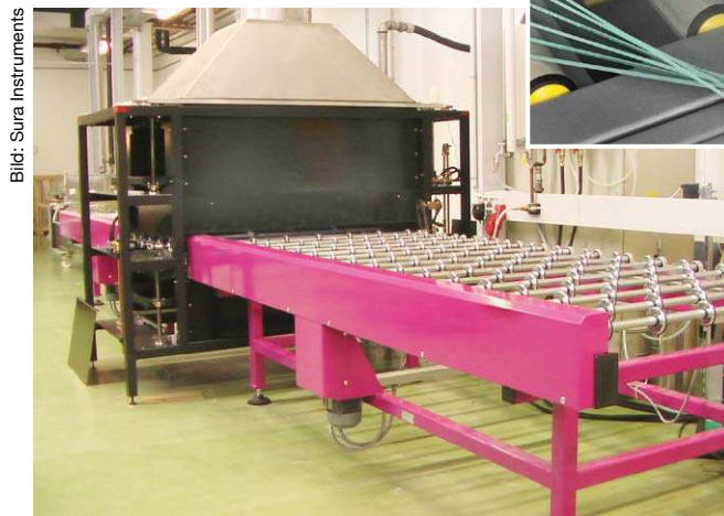
Auch großformatige Glasscheiben können im Pyrosil-Verfahren behandelt werden.
