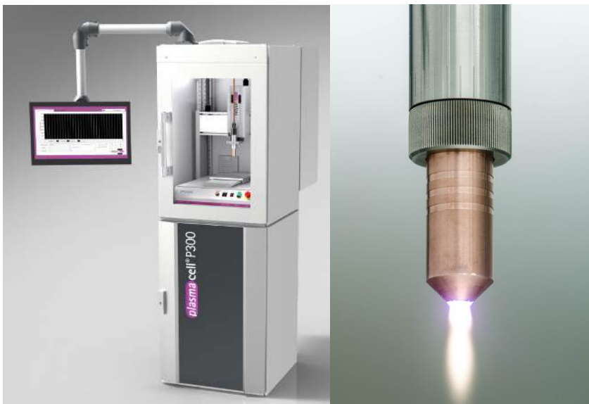
Abbildung 1 Universell einsetzbare atmosphärische Plasmazelle mit xyz-Positioniereinheit (plasmacell 300). Verfahrensgeschwindigkeit bis zu 800mm/s.
