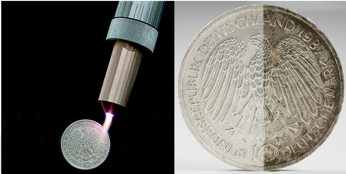
Bild 4: Reduktion einer silbernen Sondermünze. Links: Größenvergleich der Münze und der Plasmaflamme am Düsenaustritt. Rechts: Effekt der reduzierenden Plasmabehandlung mit 5% H 2 /95% N 2 auf die Münze, die vor der Behandlung zur Hälfte maskiert wurde. Der Effekt tritt bereits nach einer Behandlungsdauer von ca. einer Sekunde auf. Siehe auch Schmitt-Ott, 2009.
