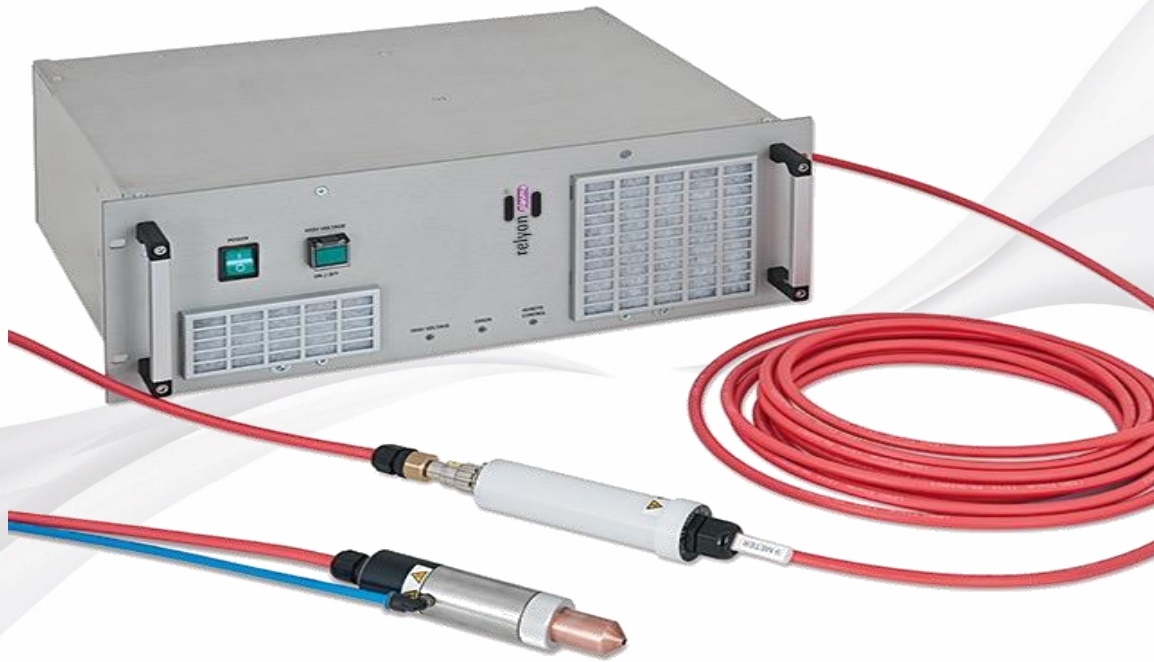
Bild 1: Plasmasystem bestehend aus einem 19Zoll Leistungseinschub für die Hochspannungversorgung (PS2000), einem robusten und flexiblen Verbindungskabel und dem kompakten Plasmaerzeuger PB3 mit Düsenaufsatz (A450). Das System kann betrieben werden mit Luft, Stickstoff und reduzierendem Formiergas ( H_2/N_2 ).
