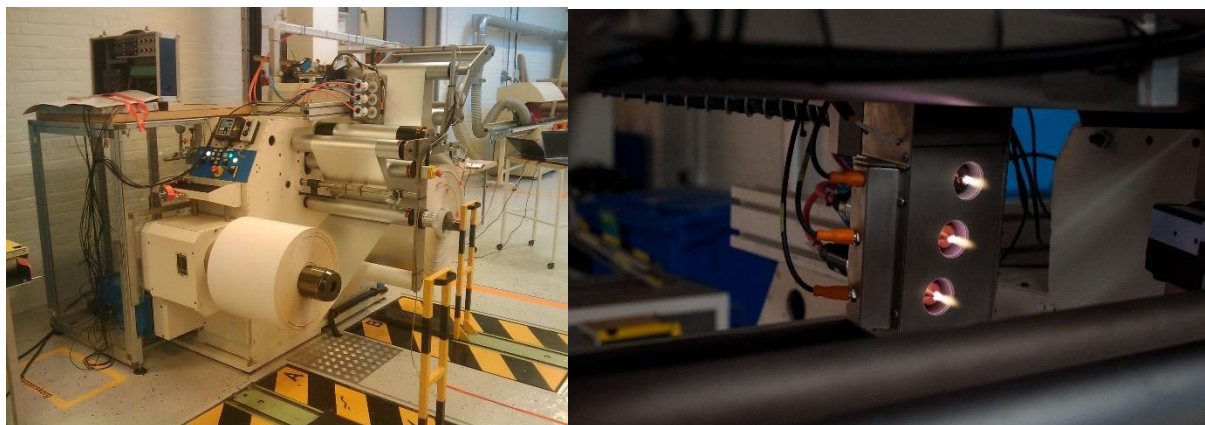
Abbildung 4: Behandlung von Aluminiumfolien im Roll-to-Roll-Verfahren
