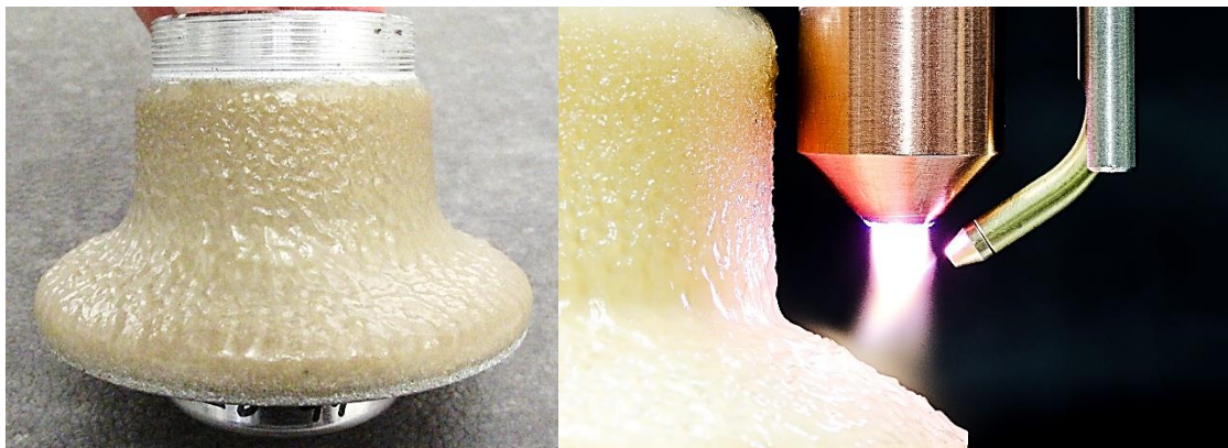
Abbildung 5: Vollendete Hot Melt-Beschichtung (links) und Plasmabrush® mit externer Injektion (rechts).
