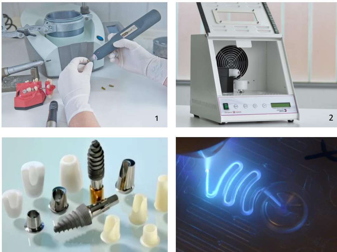
Abbildung 3: P22 Handgerät, Bild 1, im Laboreinsatz bei der Vorbehandlung von dentalen Materialien (anorganisch gefüllte Kunstharze, PEEK, Titan). Bild 2 zeigt eine industriell eingesetzte Variante für die Oberflächenbehandlung nach voreingestellten Parametern.
