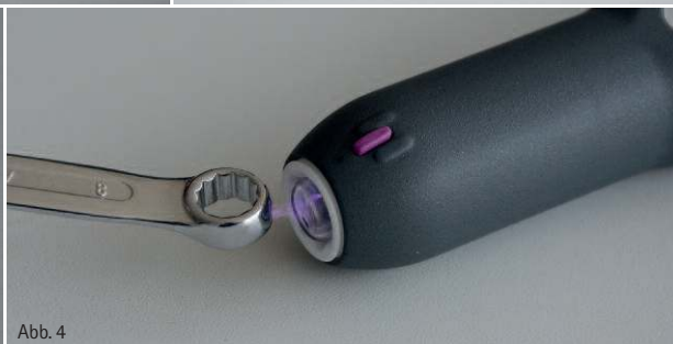
Abb. 1 bis 4: Düsenansätze für verschiedene Anwendungsfälle (1, 2) Nadeldüse für die Innenbehandlung von Sacklöchern und Kavitäten und die Nutzung von Sondergasen. Düsenansatz für die flächige Behandlung von sensiblen oder leitfähigen Oberflächen (3,4).
