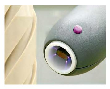
Die Plasmafunktionalisierung zerstört eventuell auf der Implantatoberfläche vorhandene Mikroorganismen und erhöht die Oberflächenenergie, so dass sie für Blut und andere Körperflüssigkeiten besser benetzbar wird
