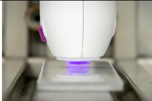
Oberflächenbehandlung eines Glas Probekörpers mit dem piezo brush ® PZ2. Die Dauer der Behandlung beträgt ca. 5s/cm 2 .
